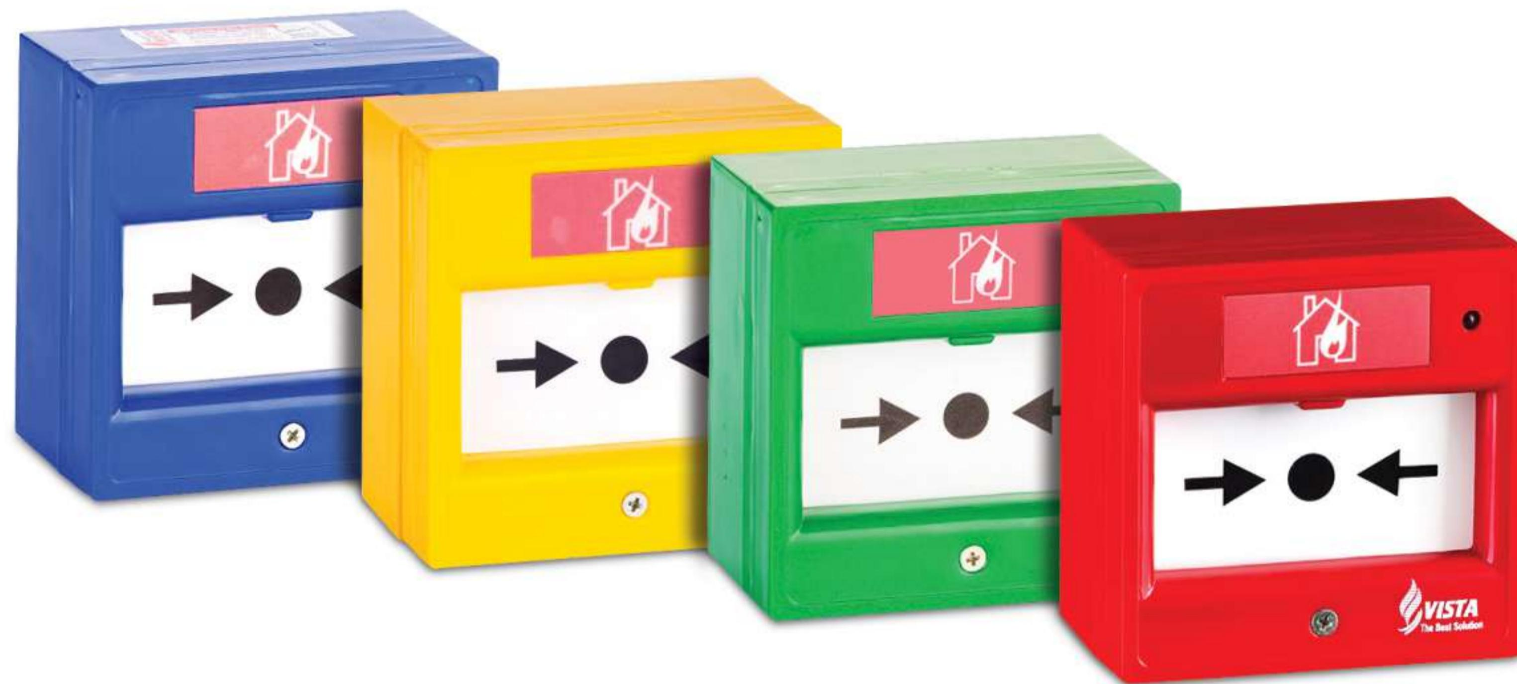
شستی اعلام حریق ویستا با هدف اعلام دستی خطر در شرایط اضطراری طراحی و تولید گردیده است. با فشار دادن شیشه نشکن روی شستی، شرایط اضطراری وقوع حریق به دستگاه مرکزی اعلام حریق ارسال می شود. طراحی شستی فوق مطابق استاندارد ملی ۶۱۷۴ و مطابق استاندارد ۱۱ EN54 PART 11 اروپا انجام پذیرفته است. شستی مدل MH-218 از بدنه ABS به رنگ قرمز و مقاوم در برابر ضربه با ظاهری زیبا طراحی و تولید گردیده است. جعبه پشت شستی امکان نصب تو کار یا رو کار را میسر می نماید.
